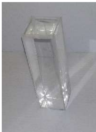
شکل ۱: مینی فانتوم‌های طراحی شده از جنس سروبند و آب برای اندازه گیری با فیلم گاف کرومیک EBT2
