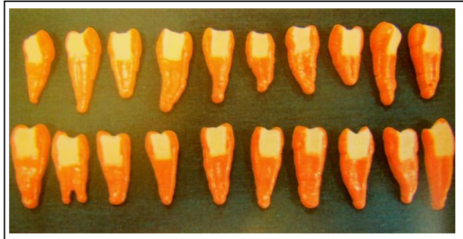
شکل ۱: لاک زدن روی تمام نمونه‌ها
