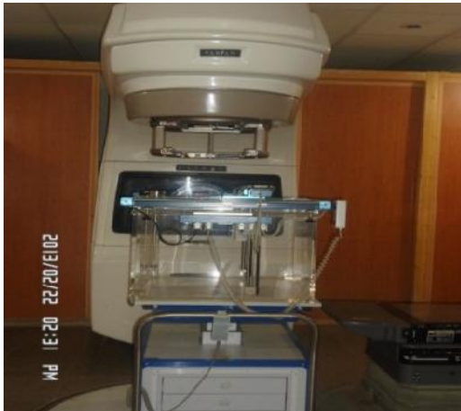
شکل ۲: تنظیم دزیتر در مرکز میدان تابش
