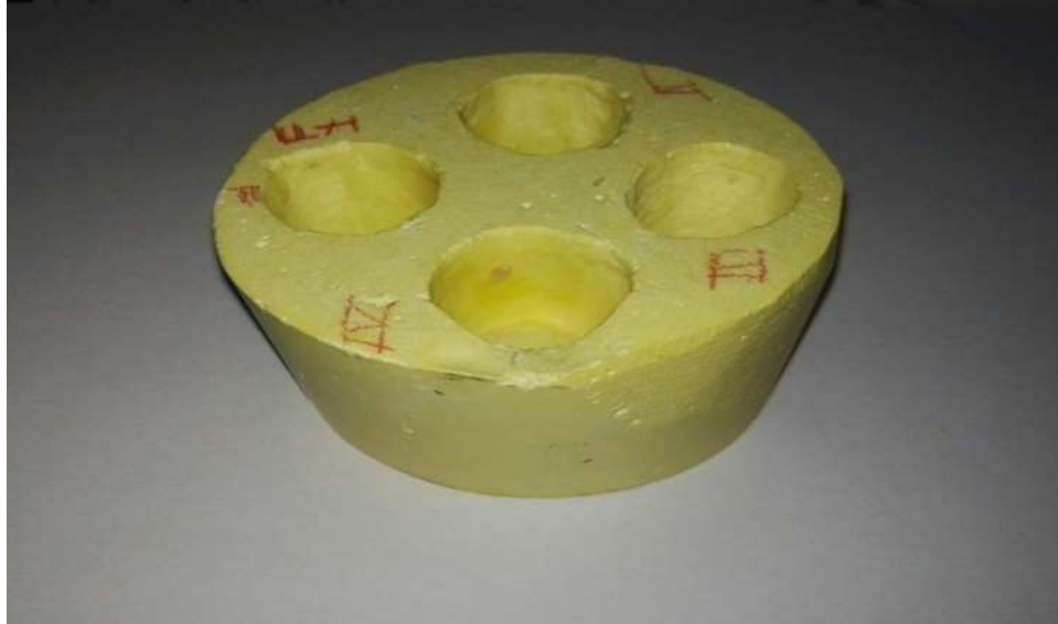
شکل ۱. بلوک استفاده شده در مطالعه (مخلوط گچ و اکریل) و چهار حفره مشابه برای قرارگیری همزمان نمونه‌ها درون بلوک
