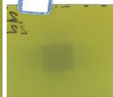
شکل ۲: (الف) فیلم گاف کرومیک EBT2 تابش دیده، برای اندازه‌گیری فاکتور پراکندگی کولیماتور با استفاده از Top
