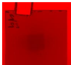
شکل ۲: (الف) فیلم گاف کرومیک EBT2 تابش دیده، برای اندازه‌گیری فاکتور پراکندگی کولیماتور با استفاده از Top
